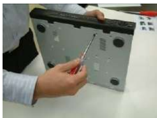
④ 安裝固定硬碟螺絲
