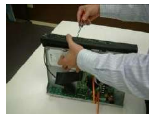
③安裝固定硬碟螺絲
