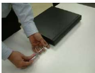
①拆卸主機上蓋的固定螺絲
